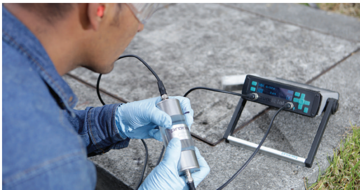
← Calibración del equipo para ensayo de ultrasonido. ARCHIVO ASOCRETO
