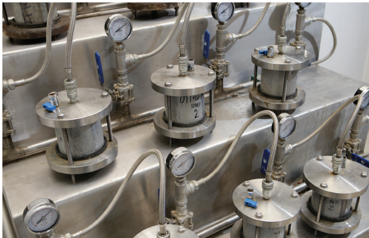
← Ensayo de permeabilidad al concreto según la norma NTC 4483. ARCHIVO ASOCRETO
