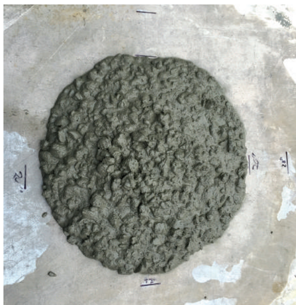
← Figura 3. Mezcla SCC con un flujo de 50 cm el cual se mantiene durante 45 minutos.
